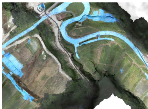
図 4 地すべり地区全景と標高変動量（7月5日から9月28日までの変化）
