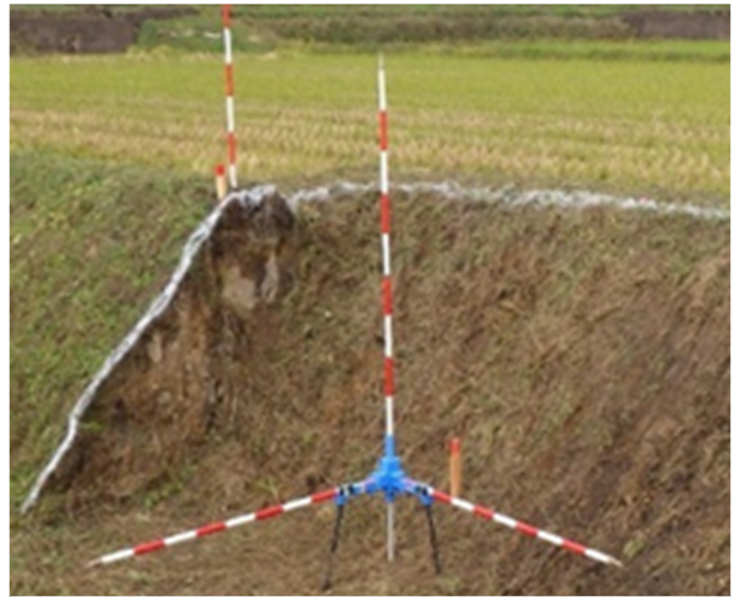
図 4 三軸座標規 (測量用ポールを支えるのが『三軸ん』)
