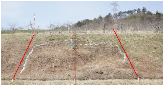
図 6 測定精度を検証した超小規模崩壊地と検証位置
